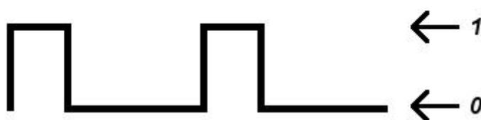
No PWM (Pulse Width Modulation) a técnica da modulação da onda na largura de pulso consiste na variação da largura da portadora, na proporção do sinal e mantendo constante a amplitude e o intervalo de tempo em cada frame.
