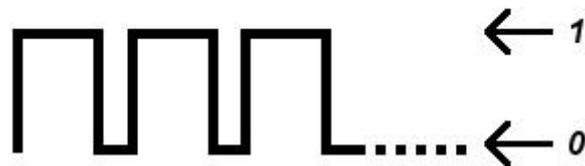
No PPM (Pulse Position Modulation) a técnica de modulação de posição de pulso consiste na variação da posição de pulso da portadora, na proporção do sinal, mantendo constante a amplitude e a largura dos pulsos. De notar que o intervalo entre os pulsos pode não ser constante.
