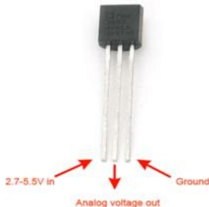
O TMP36 é um sensor electrónico de baixa voltagem que fornece um output linearmente proporcional à temperatura em graus Celsius.
