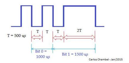
Para conseguir realizar medidas nesta escala de tempo, a nível de micro-segundos, recorre-se na elaboração do programa do micro-controlador a técnicas e funções, conforme é no caso deste projecto (timmers, interrupts, etc.) que determinam o momento exacto em que o sinal muda, de ligado para desligado, atribuindo a uma variável o tempo decorrido.
